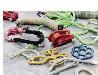
▲吊り下ろしに使用する器具類。耐荷重が明記されています
