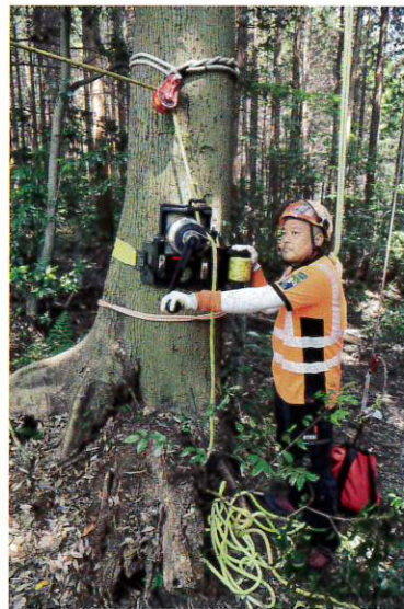
▲ロープを張り上げたり、吊り荷に制動をかけたりする際に、手動ウインチを使います
